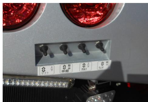
② 上下スイッチで下げながら「チルト使用」しながら高さ、平行を見ながらセッティングしてください。ブームを下げたら次は『チルトの上下』で平行にして→上下の下げで高さ調整してください。
