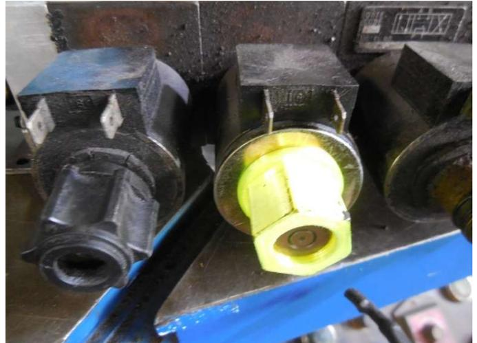
⑨締め付け後製品と内部のナット部のクリアランスを計測
