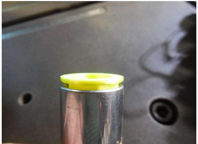
\*上記の様に若干クリアランスがないと押さえ部分が破損します。
