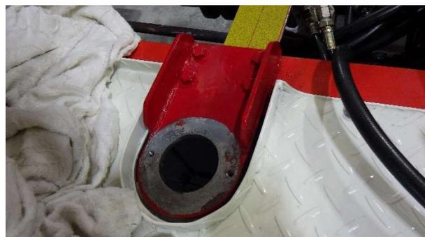
⑤ 油圧ホースを外す～アウトリガーを使用しない時は別な油圧機器の動力源として利用可能です。
